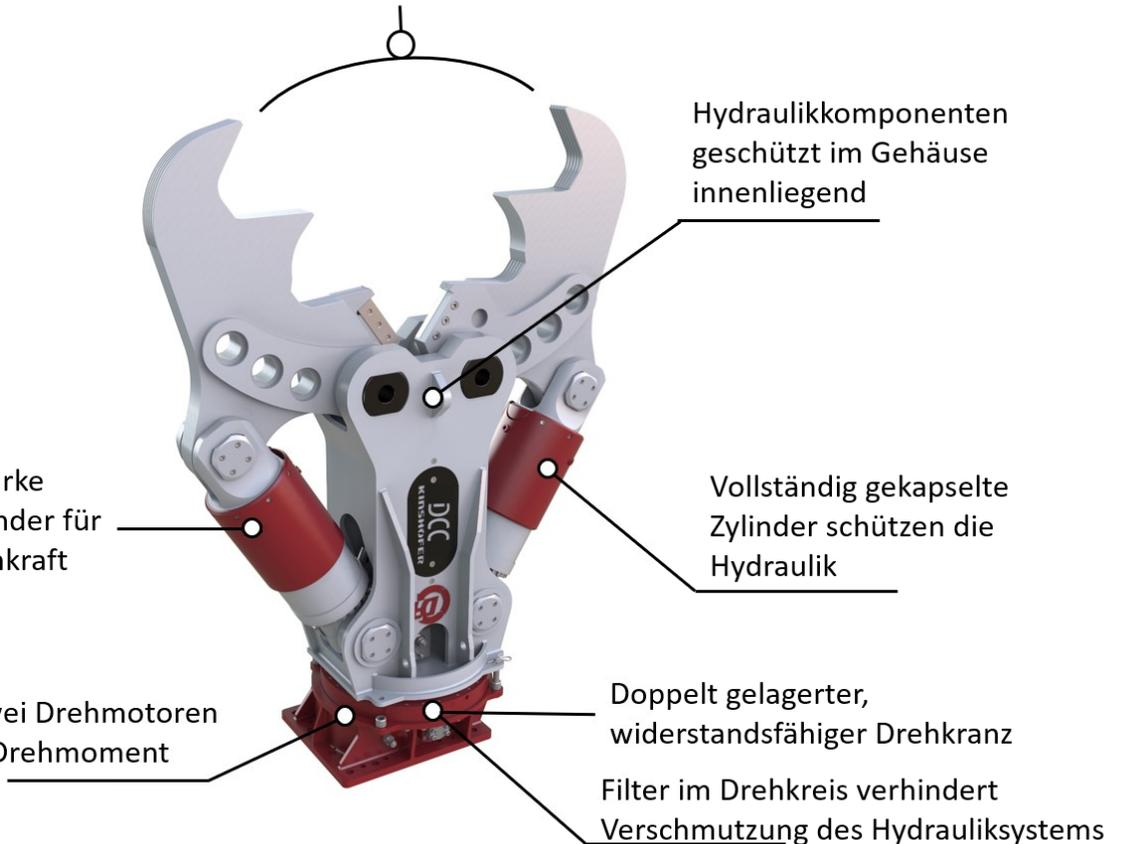
DCC Abbruchscheren mit zwei Zylindern sind speziell für den Rückbau von Objekten mit großen Wandstärken und Armierungen entwickelt: Zum Beispiel Brückenpfeiler, schwere Fundamente, Viadukte. Das 2-Zylinder-Konzept erlaubt eine symmetrische Bauform, damit sind die Scheren auch besonders gut für Longfront-Einsätze geeignet. Durch die beiden DemaPower-Zylinder besitzt die Schere 20% mehr Brechkraft als herkömmliche Scheren.
