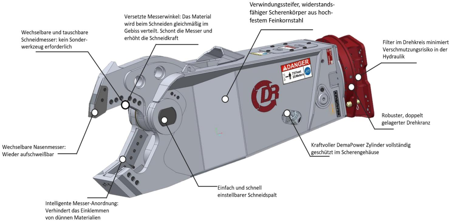
Mobile Schrottscheren müssen sowohl leicht und kompakt, als auch kraftvoll und widerstandsfähig sein. Die Baureihe Demarec Xtreme Shear (DXS) basiert auf der bewährten, leistungsstarken DemaPower Zylindertechnologie: bis zu 20% mehr Schneidkraft und schnellere Taktzeiten dank doppelt wirkender Eilgangventile. Dadurch sind die Scheren stärker, als mit herkömmlicher Zylindertechnologie, bei gleichbleibendem Einsatzgewicht.
