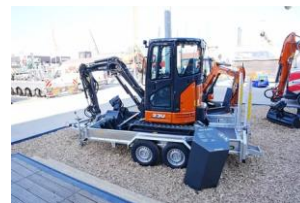
KTEG_23U-6_VA.jpg Die perfekte Maschine für den GaLaBau, optimiert für den Transport mit einem 3,6t Anhänger, der eine fest verbaute Schnellwechsleraufnahme hat.
