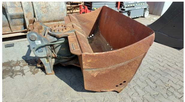
**Lehnhoff, Grabenräumlöffel schwenkbar
