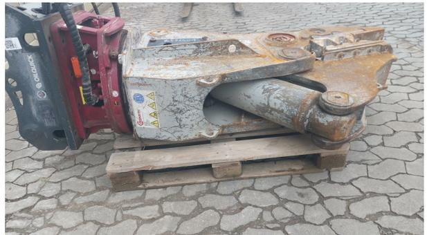
**Demarec, Betonpulverisierer DLP12,
