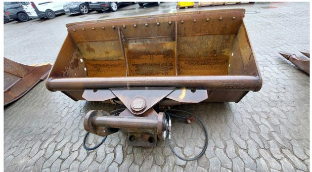
**LRT, Grabenräumlöffel schwenkbar 2400
