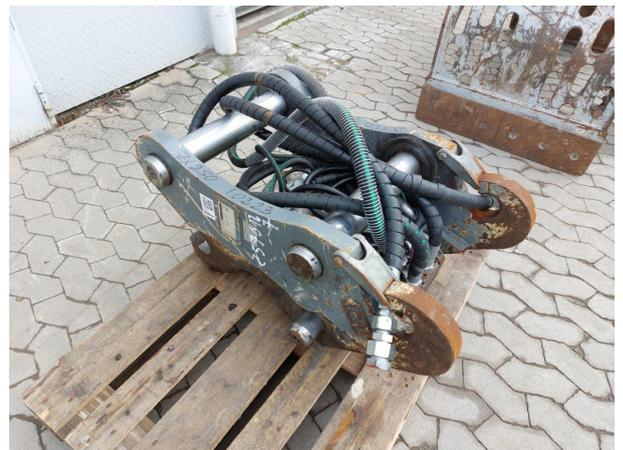
Liebherr, Vollhydraulischer Schnellwechsler SW48
