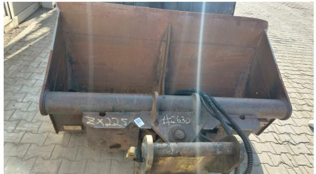
**LRT, Grabenräumlöffel schwenkbar 2000
